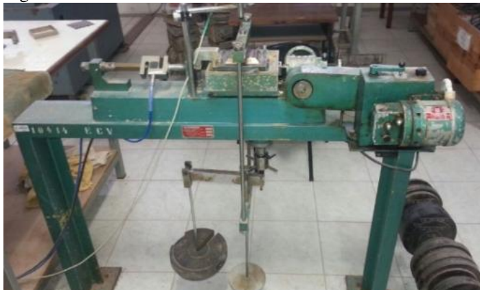
Figura 35 – Ensaio de cisalhamento direto / LabSolos UFSC
