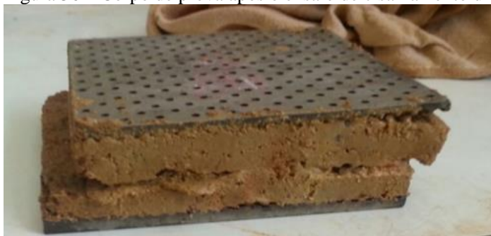
Figura 36 – Corpo de prova após o ensaio de cisalhamento direto
