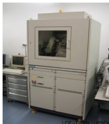
Figura 22 – Máquina de DRX Siemens D5005
