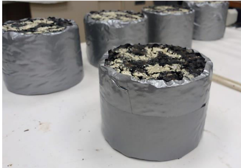
Figura 24 – Impermeabilização dos corpos de prova para ensaio de vazios comunicantes.
