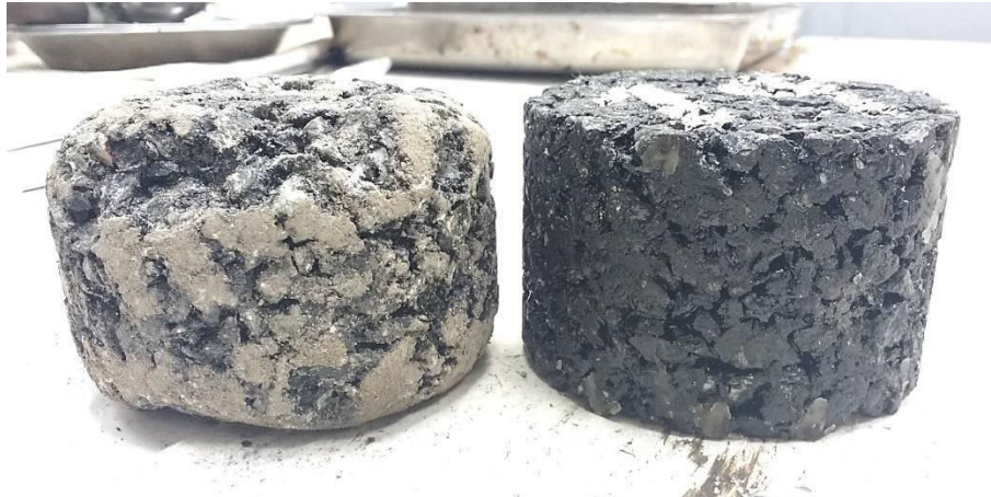
Figura 28 – Comparação dos corpos de prova BBDr antes e depois do ensaio cántabro.
