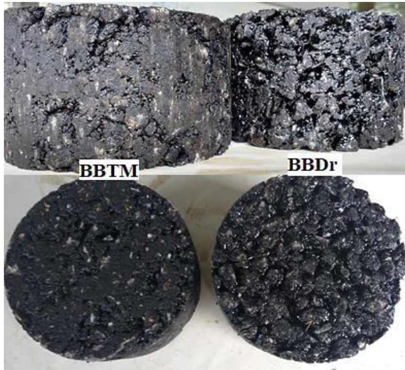
Figura 21 – Diferenças entre os corpos de prova BBTM e BBDr.
