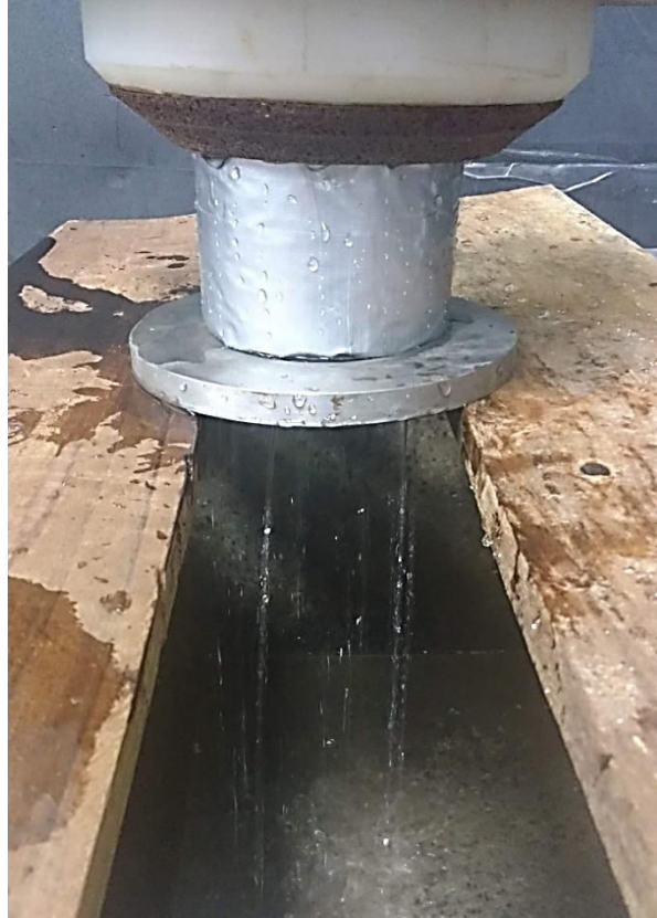
Figura 26 – Ensaio de permeabilidade.
