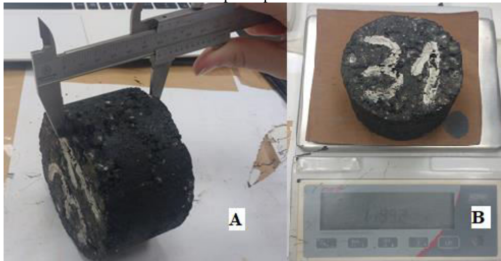
Figura 22 – Parâmetros necessários: (a) medição da altura com paquímetro e (b) pesagem do corpo de prova.
