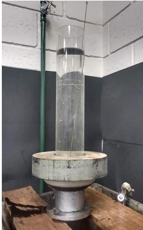
Figura 25 – Adaptação para ensaio de permeabilidade.
