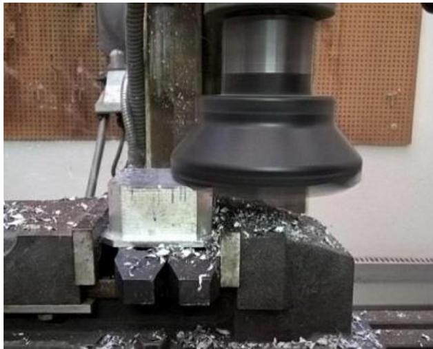
Figura 36. Fresagem do bloco de alumínio para adaptação na cavidade da máquina de moldagem por injeção.
