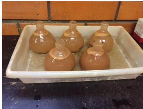
Figura 33 - Picnômetros cheios de água com solo
