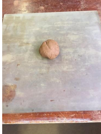
Figura 28 - Esfera conformada sobre a placa de vidro
