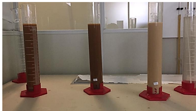
Figura 25 – Realização do ensaio de sedimentação
