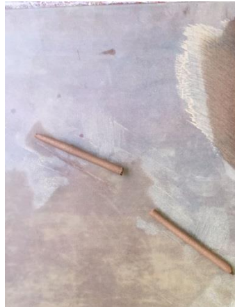
Figura 29 - Cilindro conformado sobre a placa de vidro
