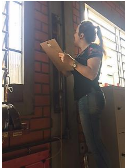
Figura 35 - Realização de leituras no permeâmetro de carga variável
