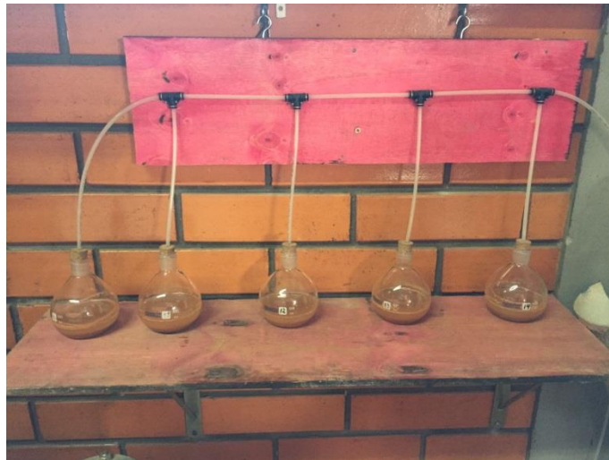
Figura 32 - Aplicação de vácuo aos picnômetros
