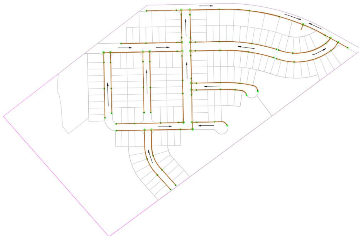
Figura 51 – Croqui de traçado da rede de esgoto
