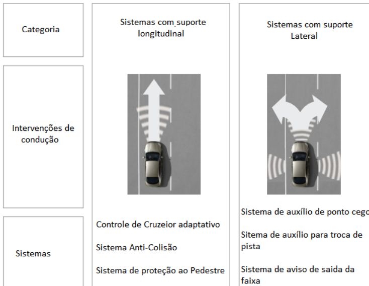
Figura 1: Exemplo de ADAS - controle longitudinal e lateral do veículo.
