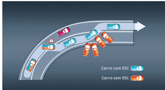
Figura 2: Exemplo de ADAS - controle de estabilidade (ESC).
