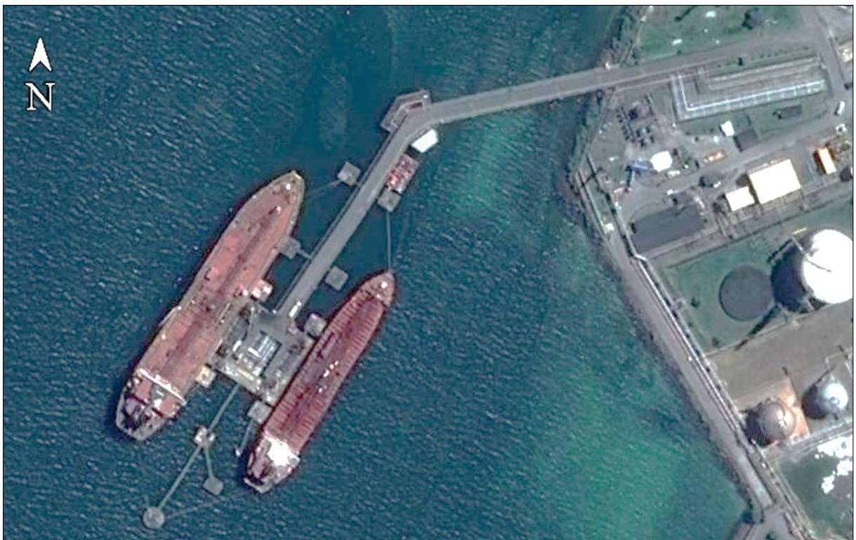
Figura 5 - Exemplo de píer discreto – Porto de Aratu-Candeias
