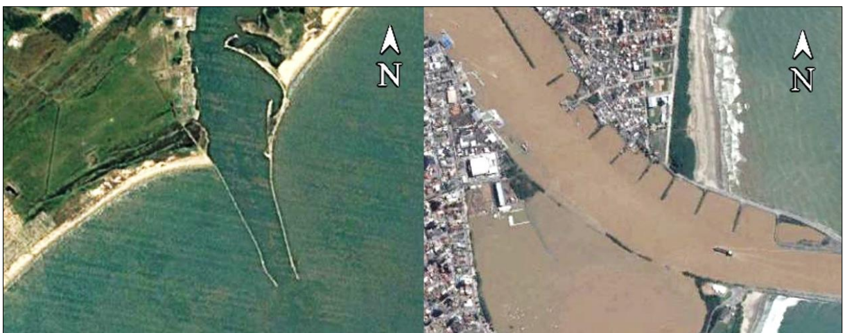
Figura 20 – Guia-corrente do Porto de Rio Grande e espigões do Complexo Portuário de Itajaí
