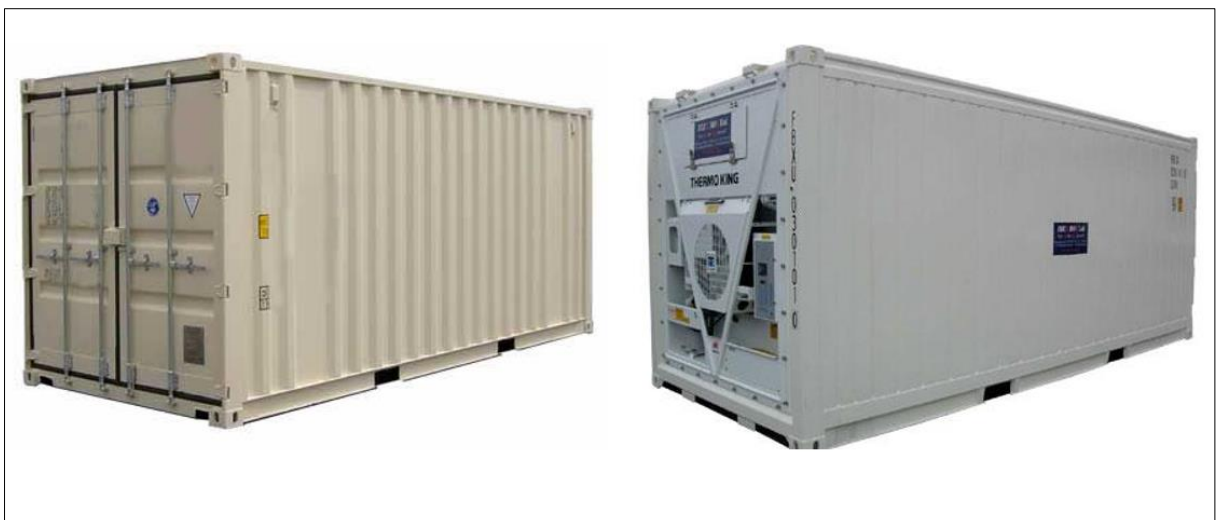
Figura 1 – Contêiner tipo Dry Box e Contêiner Reefer
