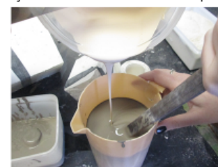
Figura 3 - Resíduo moído sendo adicionado à massa cerâmica pura.
