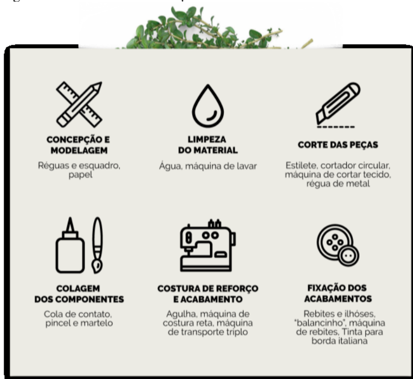
Figura 7 - Processos de fabricação de bolsas
