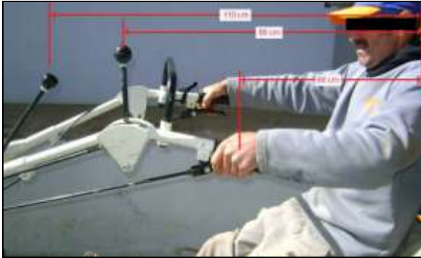
Figura 21 - Distâncias entre os pontos de referência (articulação nos ombros) e os principais comandos do motocultivador
