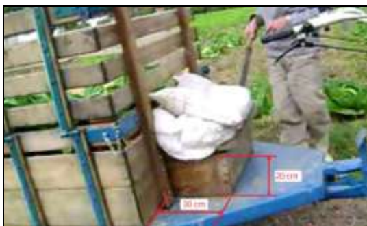
Figura 20 - Dimensões do assento do motocultivador
