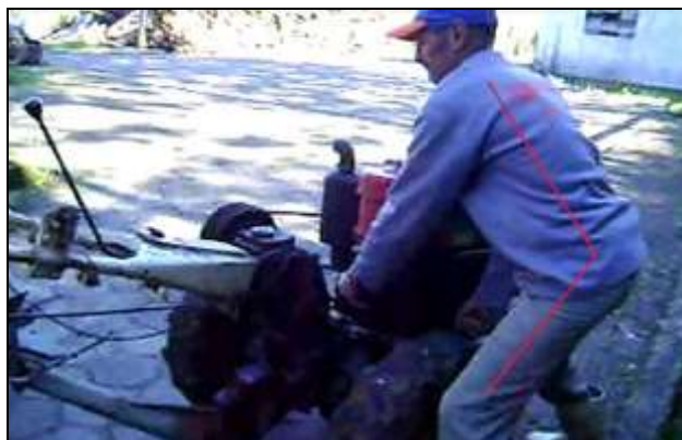
Figura 23 - Procedimento de partida do motocultivador
