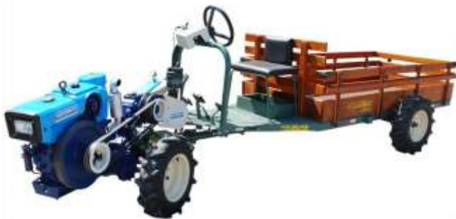
Figura 46 - Kit de adaptação para Motocultivadores com volante e carreta traçada
