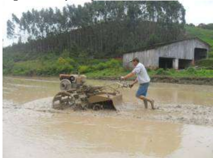
Figura 4 - Aplicação de motocultivador com enxada rotativa acoplada
