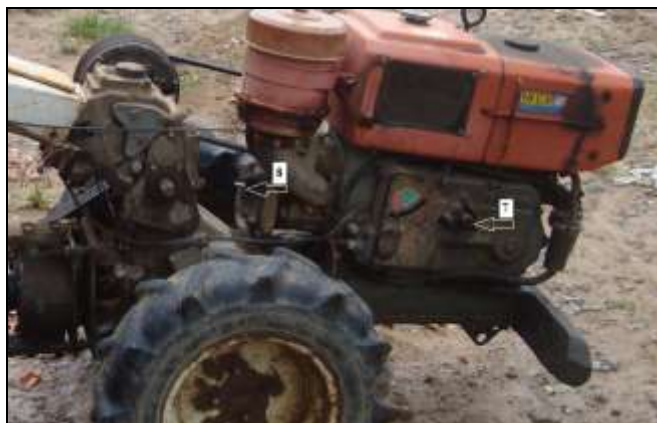
Figura 8 - Comandos utilizados na partida do motocultivador
