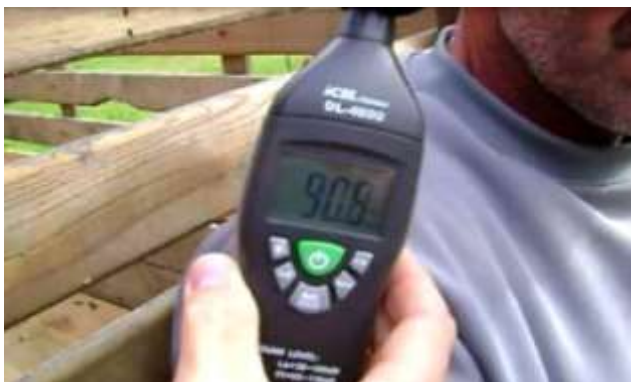
Figura 29 - Evidência de ruído próximo aos 90 dB(A) em rotação de trabalho
