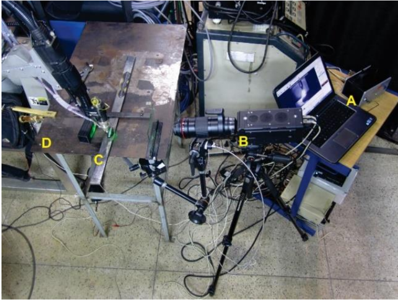
Figura 28 – Bancada experimental utilizada para a execução dos ensaios de filmagem de alta velocidade. Interface de comunicação entre câmera de alta velocidade e computador (A), Câmera de alta velocidade (B), Corpo de prova (C) e Bancada (D).
