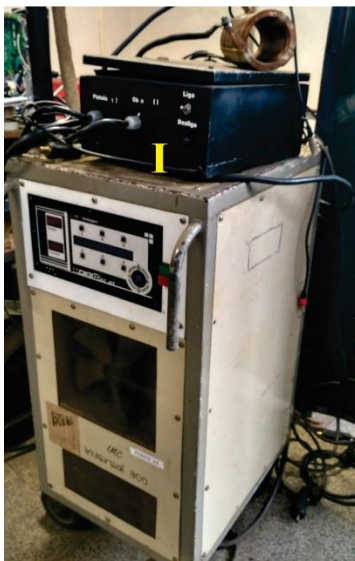
Figura 24 –Módulo de potência e fonte de soldagem fabricante IMC utilizado na integração com o sistema comercial (I).
