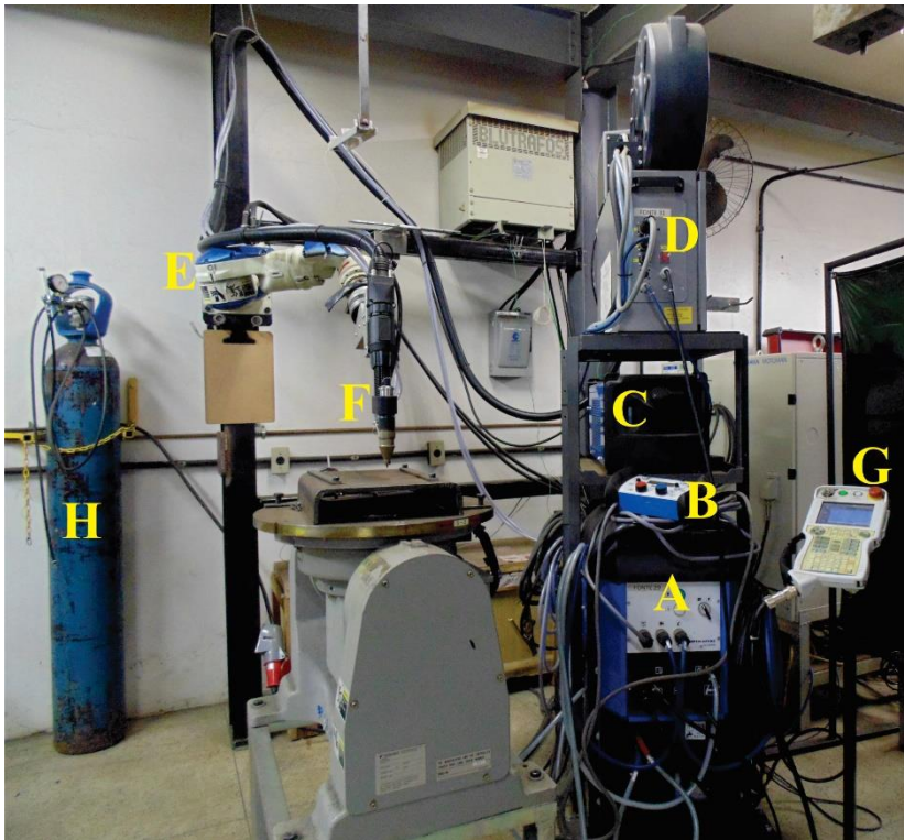
Figura 23 – Estrutura da bancada utilizada nos ensaios; Fonte de soldagem modelo TOPTIG 220 DC (A), IHM da fonte (B), Sistema de refrigeração externo (C), Sistema de controle do módulo de alimentação de arame (D), Robô antropomórfico modelo YASKAWA SIA10D (E), Tocha de soldagem TOPTIG (F), IHM do robô (G) e Cilindro de gás (H).
