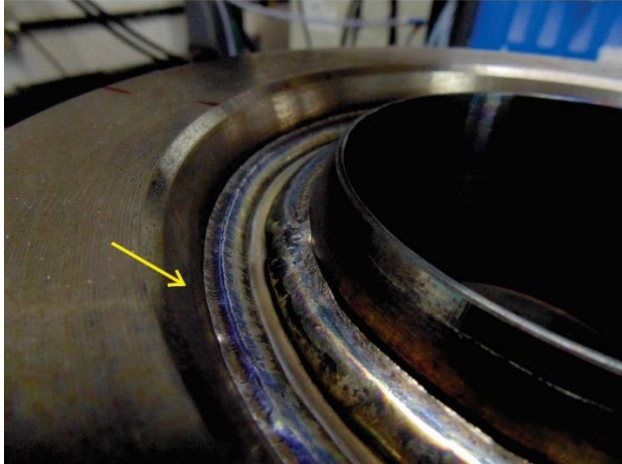
Figura 52 – Condição do chanfro após a execução dos passes de preenchimento nos bordos do chanfro (Etapa 3).
