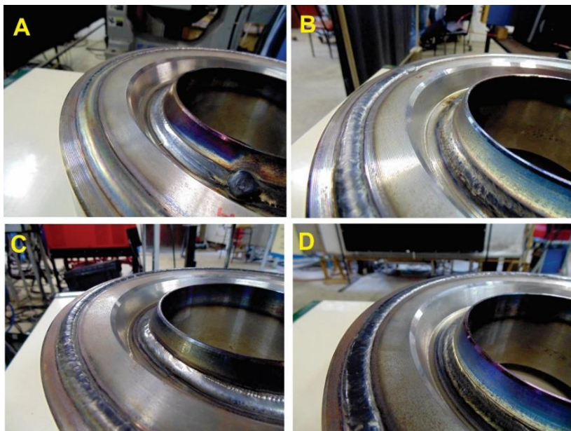
Figura 57 – Passe de preenchimento realizado utilizando a rotação do robô no entorno da geometria do corpo de prova.
