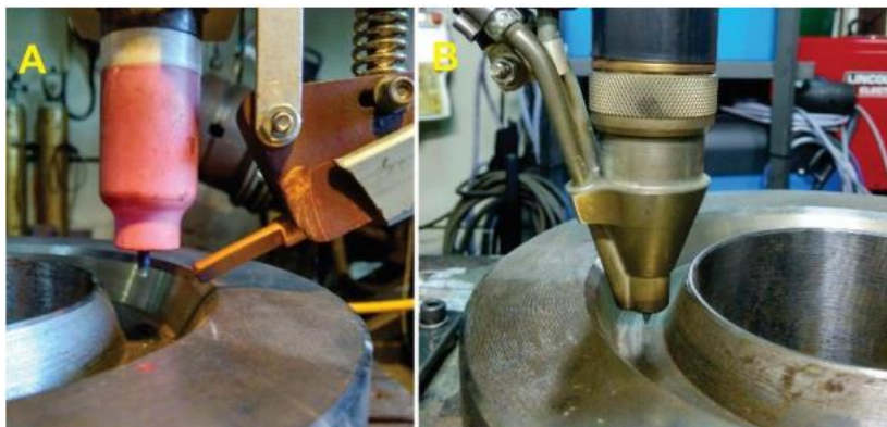
Figura 31 – Comparação entre tochas TIG fixadas no robô antropomórfico que utilizam diferentes ângulos de inserção de arame. Alimentação radial (A) Alimentação tangencial (B). Nota-se a impossibilidade de aplicação da tocha com alimentação radial no interior do chanfro por aspectos geométricos. (42).
