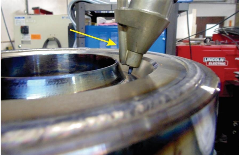
Figura 58 – Ilustração de reposicionamento da tocha em função da proximidade da parede do chanfro e a região de passagem do arame (seta amarela).
