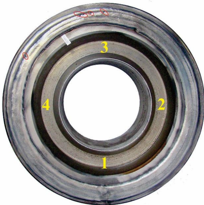
Figura 56 – Procedimento de sobreposição de passes na face do corpo de prova utilizando a movimentação do robô. As regiões indicadas referem-se à posição de inserção do arame. (1) Lateral; (2) Frontal; (3) Lateral; (4) Traseira.
