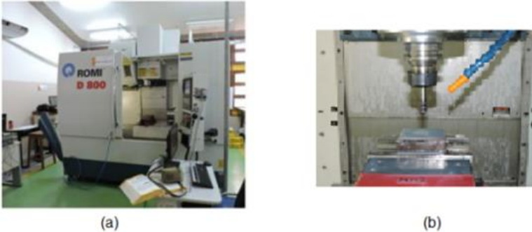
Figura 3.6 – (a) Centro de usinagem Romi D800 AP, (b) cone ISO 40 com porta pinça DIN 2080 e esquema de fixação do corpo de prova à mesa da máquina.
