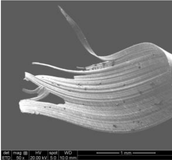
Figura 4.10 – Detalhe das discontinuidades na região de saída do cavaco gerado no desbaste em corte concordante na trajetória em curvas paralelas.
