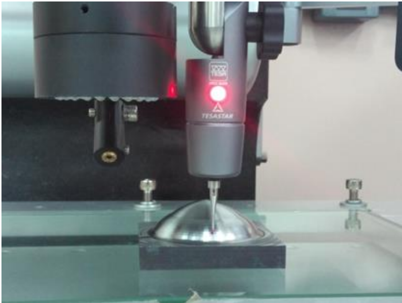
Figura 3.17- Medição por coordenadas de dois círculos (região 1 e 2) para fins de comparação dos desvios gerados em cada trajetória em relação ao modelo 3D.
