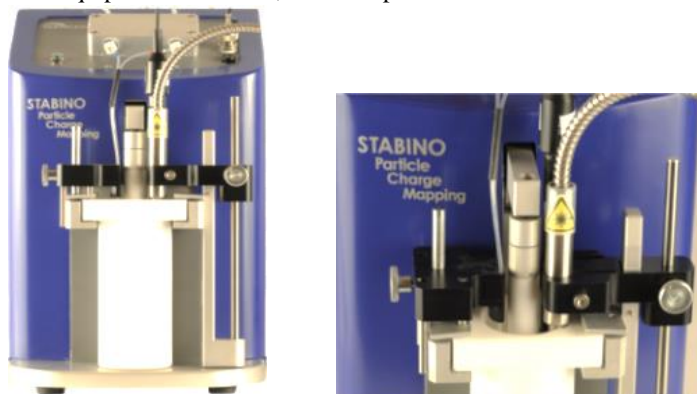
Figura 15 – Equipamento Stabino, utilizado para determinar o Potencial Zeta.
