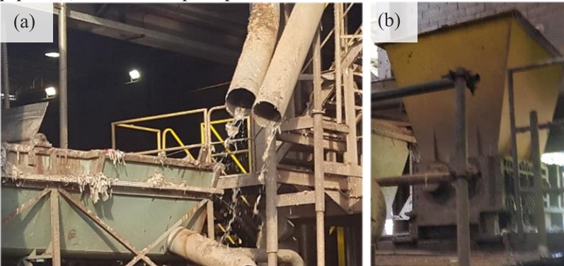
Figura 2.5 - (a) Tanque de desagregação entre as aparas plásticas e a fibra de papel e (b) triturador de aparas plásticas.
