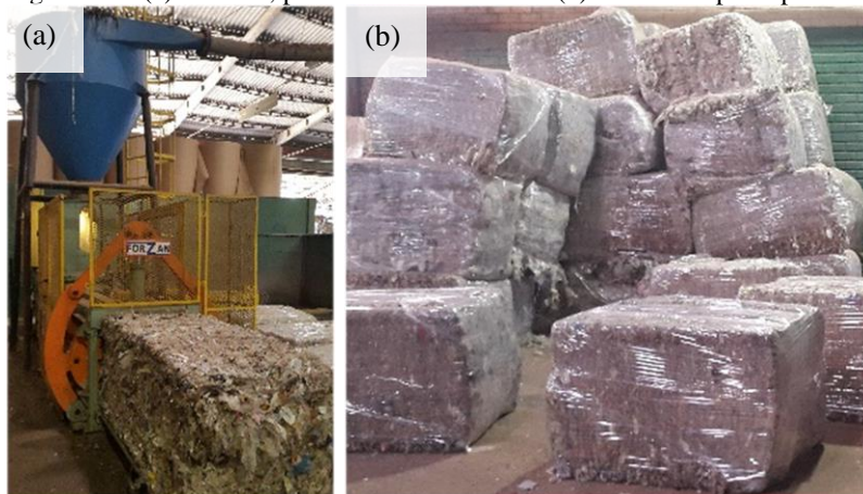
Figura 2.7 - (a) Secador, prensa enfardadeira e os (b) fardos de aparas plásticas.
