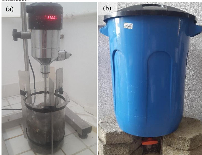
Figura 3.1 - Representação do (a) aparato experimental utilizado para dissolução de polímeros e (b) recipiente utilizado para realizar a separação por densidade.
