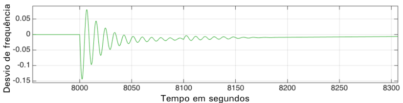
Figura 40 – Ampliação da curva de desvio de frequência da Figura 39 destacando o momento da desconexão.
