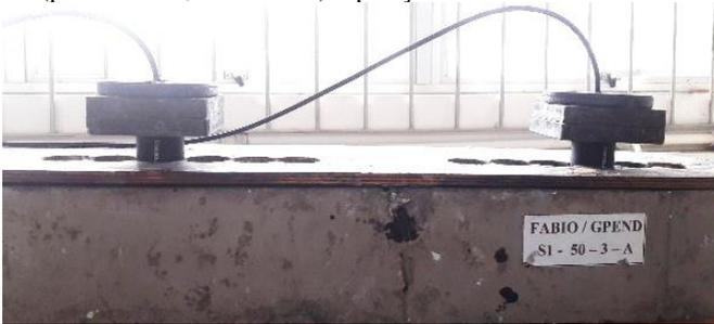
Figura 3.14 - Esquema de posicionamento e aplicação da pressão dos transdutores de 54 kHz (pressão de  $0,047 \text{ N/mm}^2$ ) - posição de leitura 250 mm.
