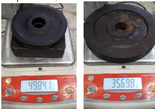
Para o transdutor de 200 kHz, efetuou-se as leituras com o peso de 3,68kg, sendo que esse peso já considera o suporte de madeira utilizado para permitir que a anilha transfira a carga para o transdutor; como a área do transdutor é de 314,16 mm<sup>2</sup> a pressão aplicada foi de 0,117 N/mm<sup>2</sup>. A Figura 3.12 apresenta a pesagem das anilhas dos suportes utilizados e a Tabela 3.4 o resumo com as pressões exercidas nos transdutores.
