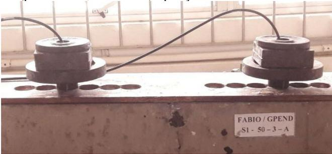
Figura 3.15 - Esquema de posicionamento e aplicação da pressão dos transdutores de 200 kHz (pressão de  $0,117 \text{ N/mm}^2$ ) – posição de leitura 150 mm.
