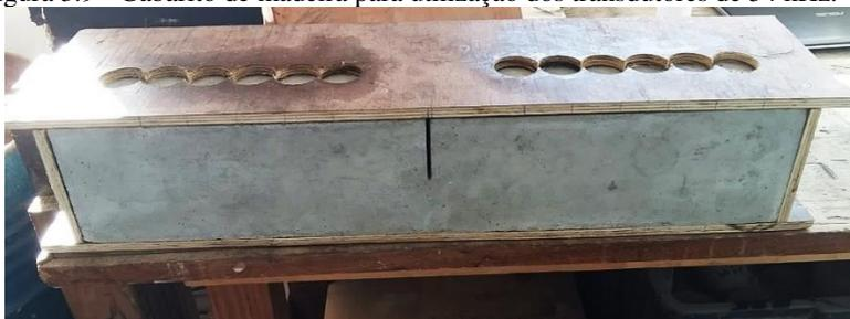
Figura 3.10 - Gabarito de madeira para utilização dos transdutores de 200 kHz.
