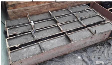
Figura 3.8 - Concreto fresco após o lançamento.
