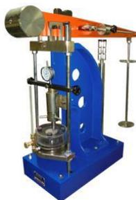
Após reunião com Engenheiros do Laboratório de Metrologia e Automação (Labmetro/EMC/UFSC), constatou-se a possibilidade de desenvolver uma prensa parecida à Bishop, com um sistema de alavanca e aplicação de carga em paralelo ou em série. No sistema em paralelo (Figura 4-3a), a carga total do sistema, necessária para aplicação da pressão, é multiplicada pelo número de corpos de prova a serem compactados. No sistema em série (Figura 4-3b), ocorre a transferência
