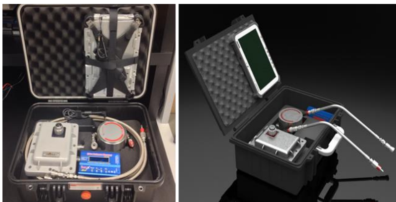
Figura 3.6– Mala contendo o sistema de calibração de densímetros, pronto para sua utilização. Fonte: Fundação CERTI
