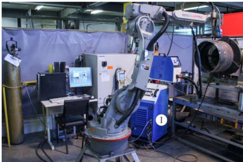
Figura 7 - Bancada soldagem com controle adaptativo com o robô antropomórfico [12].
