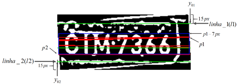
Figura 4. 18 – Detecção da ROI para segmentar caracteres
