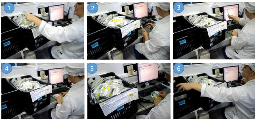
Figura 4.20 - Anotação de localização dos componentes no *feeder*
