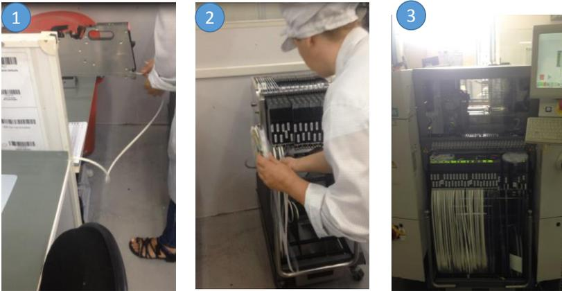
Figura 4.19 - Colocação de Componentes na máquina de inserção
