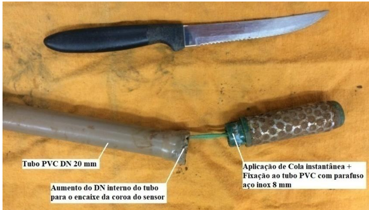
Figura 24 – Esquema de fixação do sensor aos tubos de resgate PVC.
