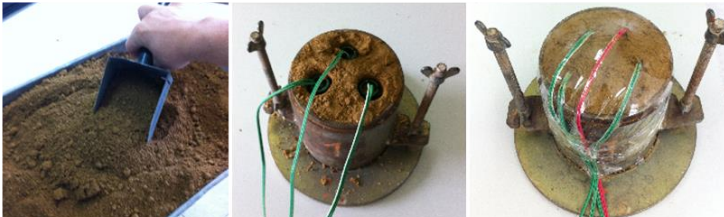
Figura 34 – Preparação da amostra com os tensiômetros de medida indireta.
