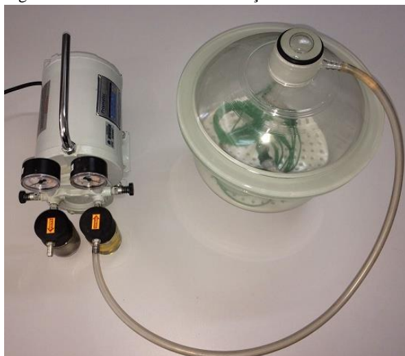
Figura 35 – Procedimento de saturação dos sensores a vácuo.
