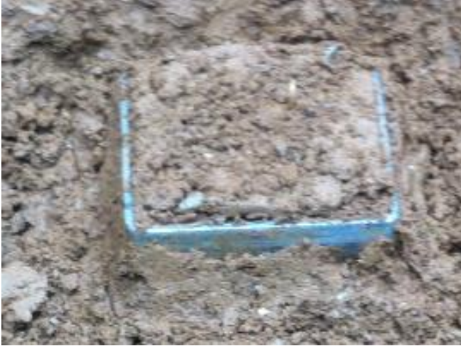
Figura 30 – Procedimento de cravação do molde de cisalhamento direto.
