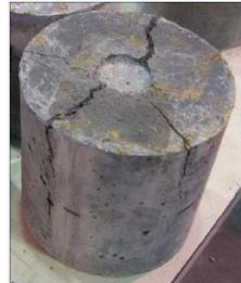
(b) Corpo de prova rompido.
