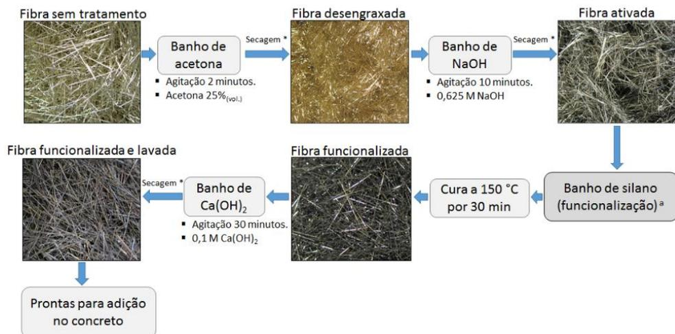
\* Secagem em estufa ventilada a 50 °C durante 12 h; <sup>a</sup> em detalhes na Fig. 77; A descrição detalhada de cada banho do processo de funcionalização é apresentada no item 6.2.
