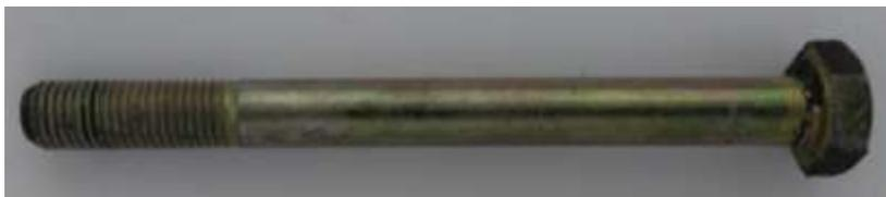
Figura 19. Parafuso de rosca parcial usado nos testes de embutimento. Fonte: autor.
