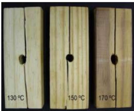
Figura 17. Falhas por fendilhamento no embutimento paralelo. Fonte: modificado de Manriquez, 2012.
