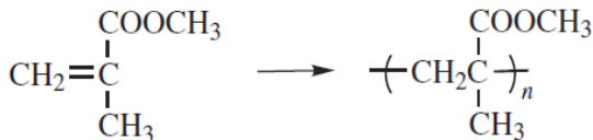
Figura 2 – Estrutura do monômero metacrilato de metila (MMA) e o respectivo homopolímero polimetacrilato de metila (PMMA)
