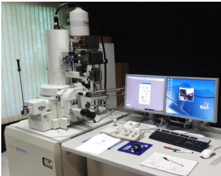
**Figura 28** Fotografia do MEV do Laboratório Central de Microscopia Eletrônica da UFSC (LCME – UFSC). Esse microscópio está equipado com um sistema de emissão de campo.
