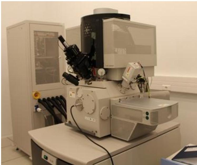
**Figura 30** Fotografia do MEV-FIF do INL, modelo Helios NanoLab 450S da FEI Company. Este equipamento foi utilizado para a obtenção dos dados de segmentação em série da nanoestrutura dos filmes de  $\beta$ -Ni(OH)<sub>2</sub>.
