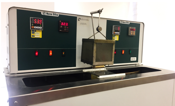
Figura 7: Espécimes sendo termociclados em banhos de 5 e 55^\circ\text{C} , com 30 segundos de imersão.
