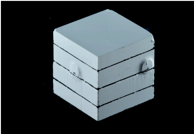
Figura 1: Bloco pré-sinterizado de zircônia com dimensões de 11 x 11 x 14 mm. Linhas foram desenhadas para guiar os cortes.
