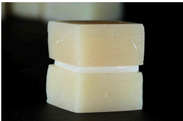
Figura 4: Conjunto conformado pelos blocos de resina composta e a zircônia no meio após fotopolimerização por 40 segundos.
