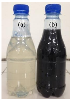
Figura 7- Fotografia mostrando as soluções teste das areias de fundição, Areia A (a) e Areia B (b).
