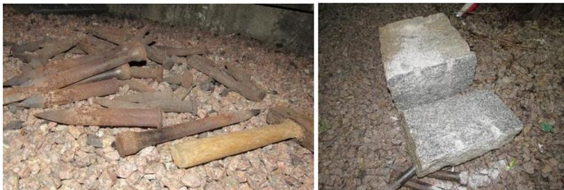
Figura 19 – ponteiros e “ponchotes” e detalhe do corte manual.
