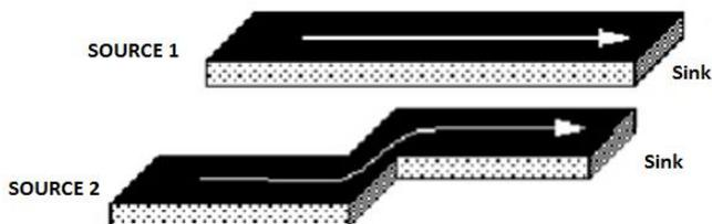
Figura 20 - Modo de excitação utilizada pelo software Q3D [53].
