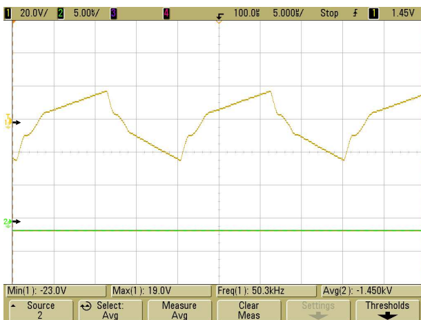
Figura 4.40 – Tensão na saída 4. Escala: V_4 = 5 \text{ kV} ; i_{Lr} = 20 \text{ A} ; t = 5 \mu\text{s} .
