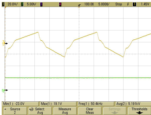
Figura 4.38 – Tensão entre as saídas 2 e 1. Escala: V_{21} = 5 \text{ kV} ; i_{Lr} = 20 \text{ A} ; t = 5 \mu\text{s} .
