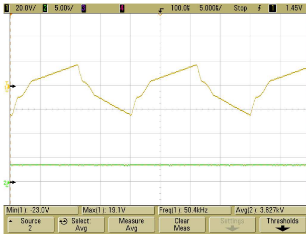
Figura 4.38 – Tensão entre as saídas 2 e 1. Escala: V_{21} = 5 \text{ kV} ; i_{Lr} = 20 \text{ A} ; t = 5 \mu\text{s} .
