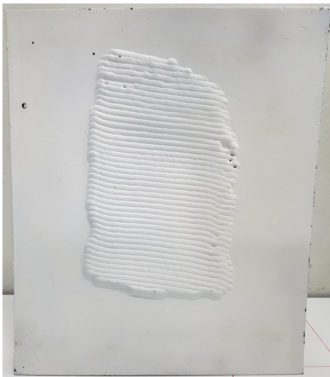
Figura 100 – Réplica de parte de região cavitada de pá de turbina hidráulica preenchida com cordões de solda.
