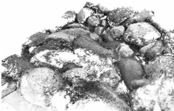
Figura 47 – Resultado de medição de cascalhos embaixo da água obtidos com o sistema AREM trinocular em diversas posições diferentes (CAMPOS et al., 2009).
