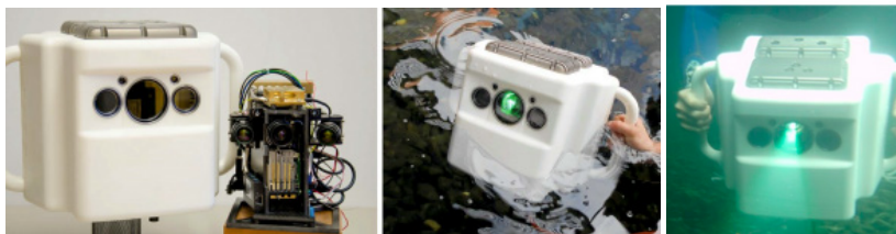
Figura 64 – Sistema estereoscópico portátil com projeção de franjas para medição subaquática (BRÄUER-BURCHARDT; KÜHMSTEDT; NOTNI, 2015) (BRÄUER-BURCHARDT et al., 2015b).
