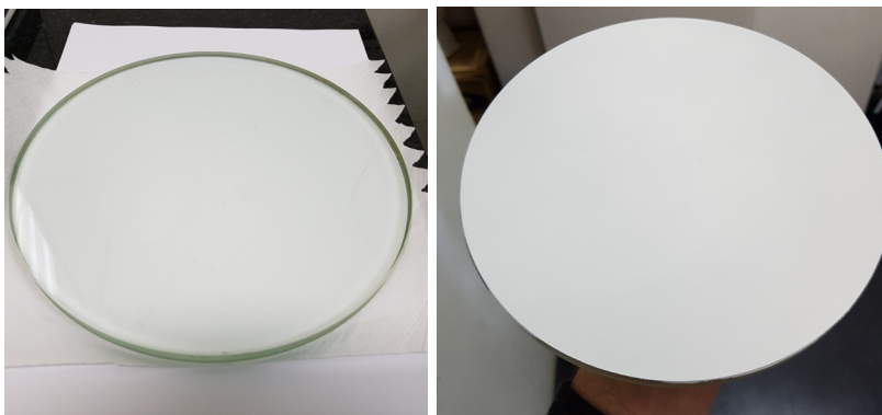
Figura 93 – Padrão plano de vidro de microscópio antes e após pintura, com respectivo erro de planeza de 3\ \mu\text{m} e 28\ \mu\text{m} . Diâmetro e espessura, respectivamente, em torno de 205\ \text{mm} e 10,2\ \text{mm} .
