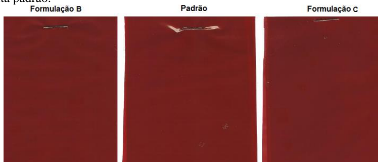
Figura 34 - Testes de resistência à blocagem das tintas preparadas com as resinas das formulações B e C em comparação com a resistência à blocagem da tinta padrão.
