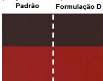
Figura 37 - Teste de transparência da tinta preparada com a resina obtida com a formulação D, em comparação com a transparência da tinta padrão.
