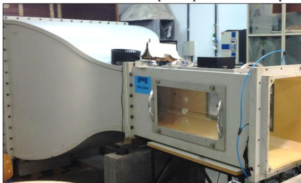
Figura 4.5. Túnel de vento utilizado para o procedimento experimental.
