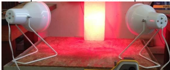
Figura 4.7. Ensaio preliminar realizado com duas lâmpadas infravermelhas.
