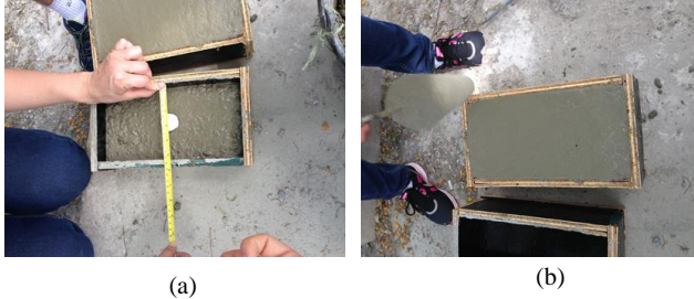
Figura 4.1. Posicionamento do disco de poliestireno durante a moldagem da amostra (a), amostra moldada (b).
