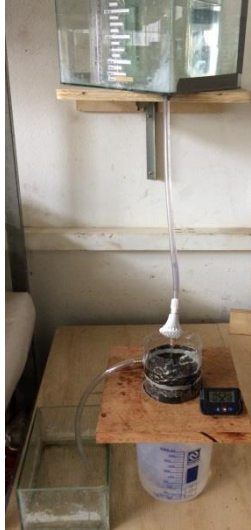
Figura 37. Permeâmetro utilizando água limpa
