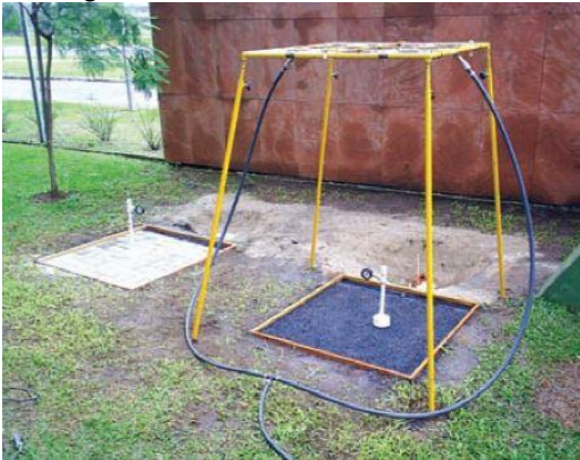
Figura 13. Modelo de simulador de chuva
