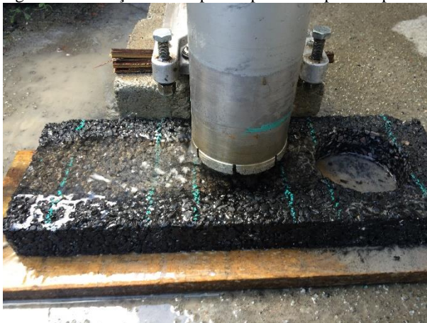
Figura 25. Extração dos corpos de prova das placas após DP
