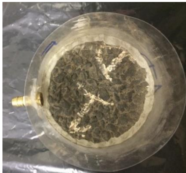
Figura 32. Vista superior do corpo de prova com vedação de cola epóxi no diâmetro
