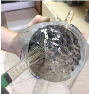
Figura 40. Material retido na superfície do corpo de prova
