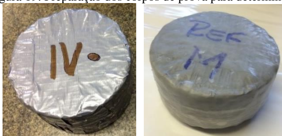
(a) Corpo de prova envolto em fita (b) Corpo de prova envolto em parafina Fonte: Elaborado pela autora
