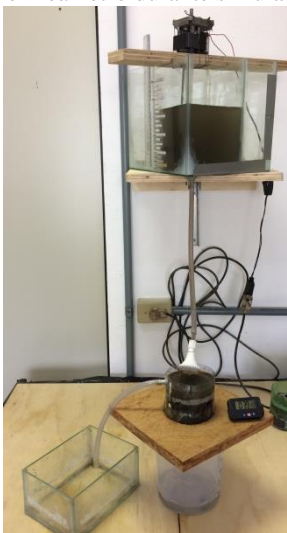
Figura 38. Permeâmetro durante simulação de chuva
