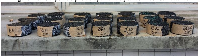
Figura 26. Corpos de prova após extração com sonda rotativa
