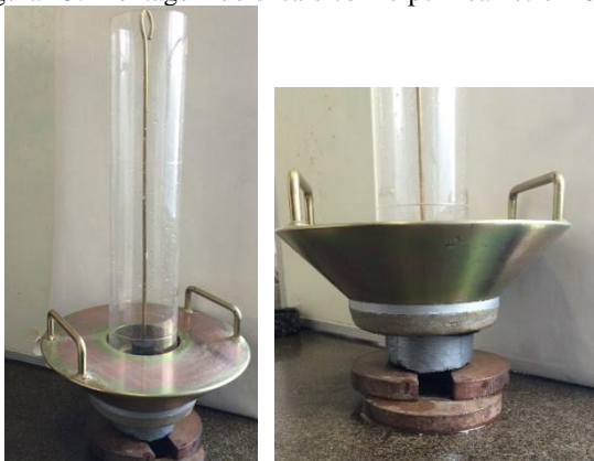
(a) Montagem sobre o CP (b) Garantia da verticalidade
