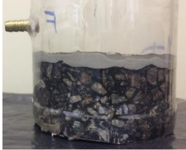
Figura 31. Corpo de prova impermeabilizada no interior do molde
