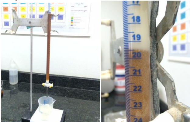
Figura 14 - Sistema de coluna de troca iônica de bancada.
