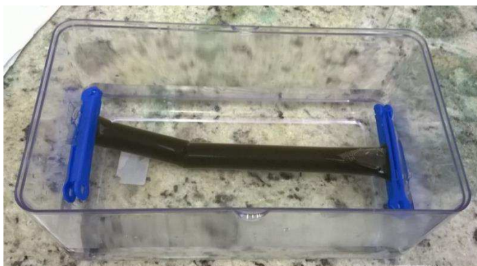
Figura 11: Saco de diálise lacrado, contendo solução de óxido de grafite, imerso em água milique
