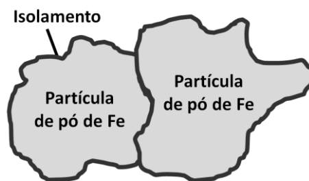
Figura 6 - Diagrama esquemático dos componentes de um SMC.
