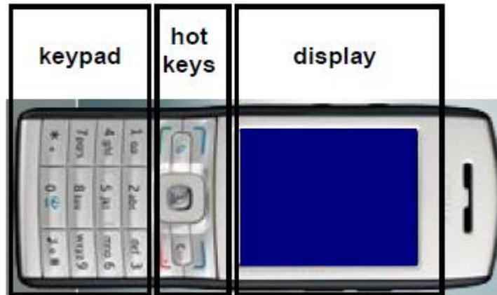
Figura 6 - Regiões de um celular. O operador mede movimentos dos olhos entre estas regiões.
