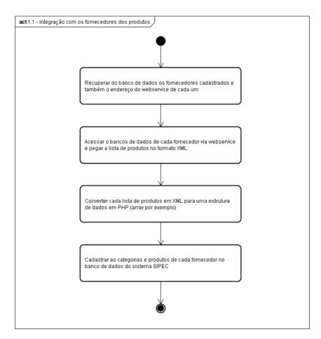
Figura 12 – Diagrama de atividades (detalhado) da etapa Integração com os fornecedores dos produtos
