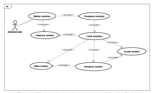
Figura 9 – Diagrama de caso de uso manter usuários (detalhado) Fonte: Elaborado pelo autor
