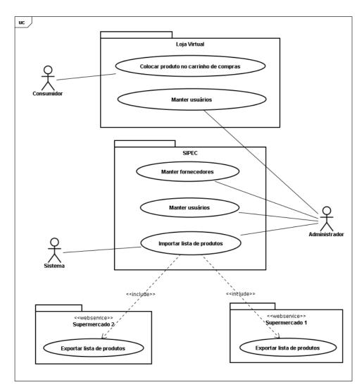
Figura 7 – Diagrama de caso de uso da visão geral do sistema Fonte: Elaborado pelo autor
