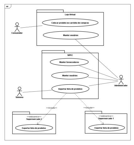
Figura 3. Diagrama de caso de uso da visão geral do sistema
