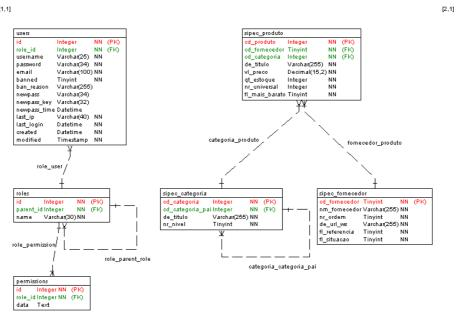
Figura 12. Diagrama ER do banco de dados integrado do sistema
