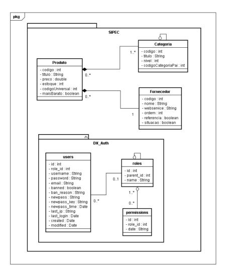
Figura 15 – Diagrama de classes do sistema Fonte: Elaborado pelo autor
