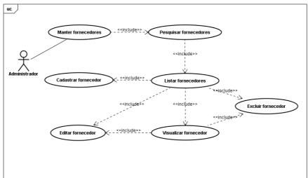
Figura 4. Diagrama de caso de uso manter fornecedor (detalhado)
