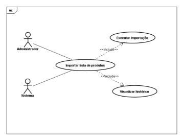
Figura 6. Diagrama de caso de uso importar lista de produtos (detalhado)
