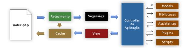
Figura 1 – Fluxograma de uma aplicação rodando no Code Igniter Fonte: Code Igniter - Guia do Usuário, 2010
