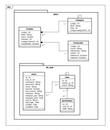
Figura 11. Diagrama de classes do sistema
