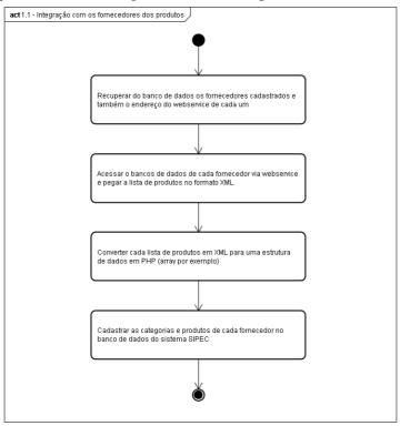
Figura 8. Diagrama de atividades (detalhado) da etapa Integração com os fornecedores dos produtos
