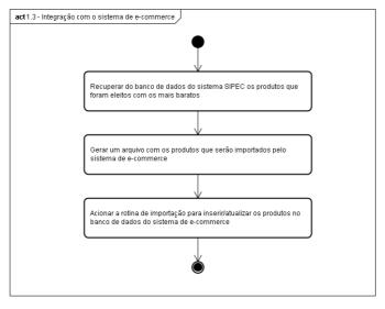
Figura 10. Diagrama de atividades (detalhado) da etapa Integração com o sistema de e-commerce
