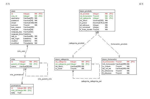
Figura 16 – Diagrama ER do banco de dados integrado do sistema Fonte: Elaborado pelo autor
