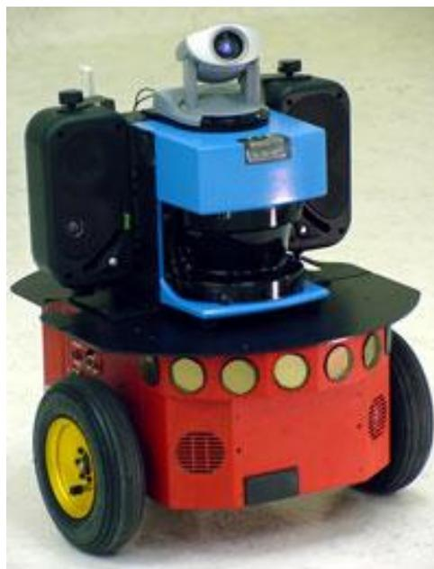
Figura 9- O robô físico Pioneer P3-DX
