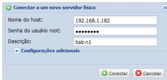
Figura 17 – Incluindo um servidor físico para ser administrado pelo OVZ-Web-Panel.
