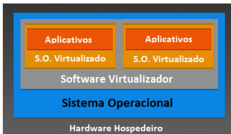
Figura 2 – Simulação de hardware para máquinas virtuais em um sistema hospedeiro.
