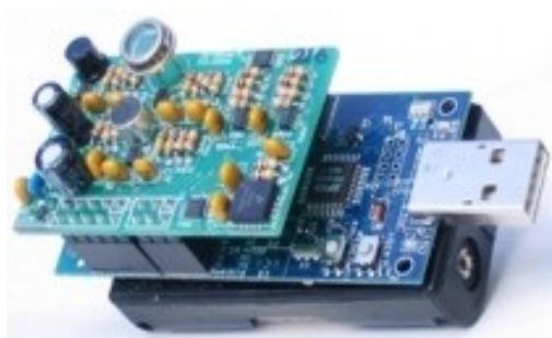
Figura 11: SBT80 conectada a uma plataforma TelosB
