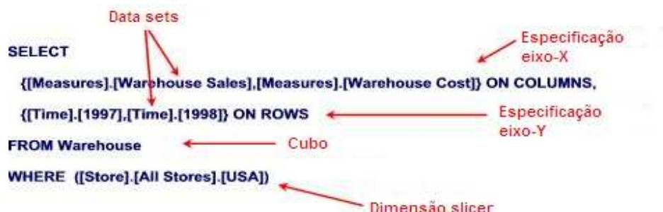
Figura 4. Estrutura detalhada de uma consulta MDX
