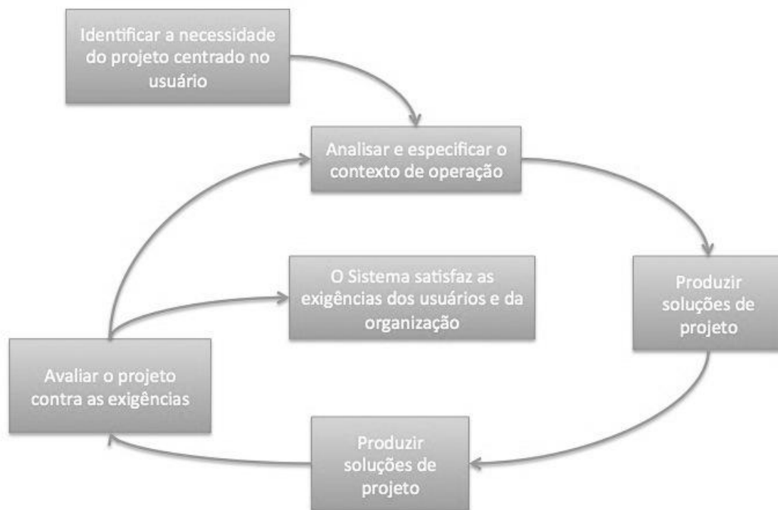
Figura 12. Fluxo de engenharia de usabilidade (ISO13407, 1999).
