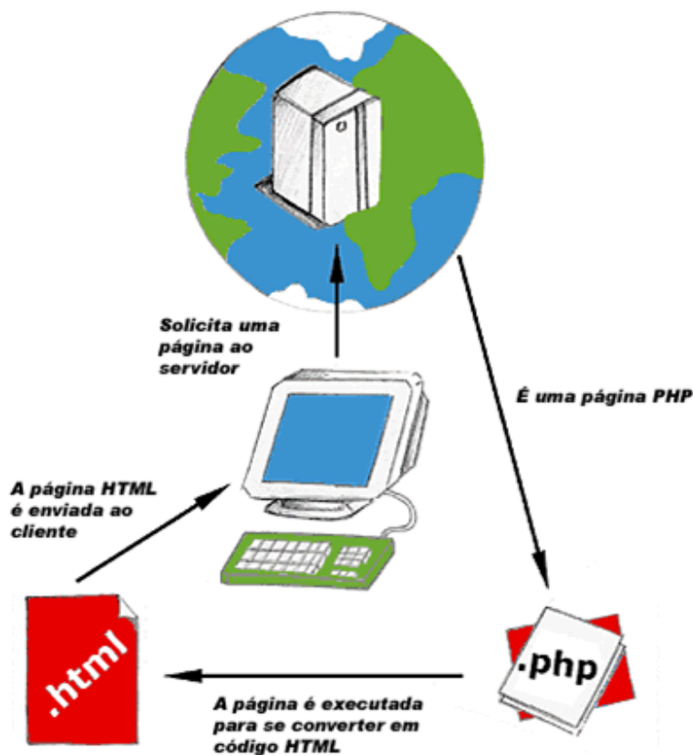
Figura 1: Esquema de funcionamento de páginas PHP.
