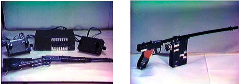
Figura 3: “ Brown Box ” e seus periféricos. Controles com botões giratórios, espingardas e pistolas com células fotoelétricas.
