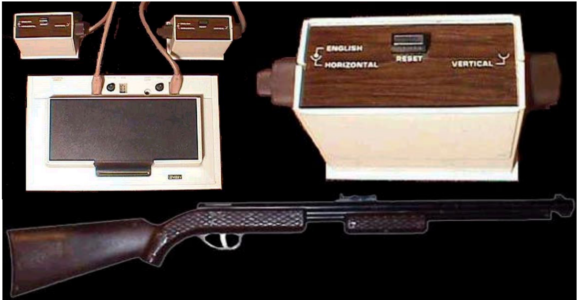
Figura 4: Na canto superior esquerda vemos o Odyssey 100 e seus 2 controles, No superior direito vemos uma ampliação do controle do videogame. Enfim na parte de baixo da figura está o primeiro rifle fabricado para videogame, baseado no rifle do protótipo “Brown Box”.
