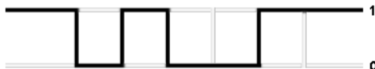
Figura 2.2: Estados lógicos do barramento em uma transmissão
