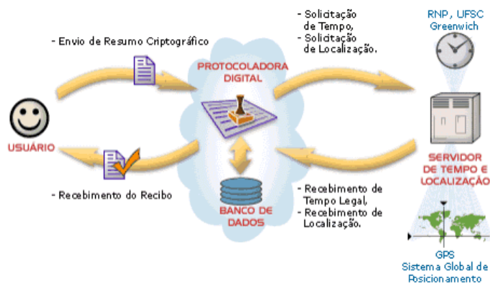
Figura 3.6: Esquema de funcionamento da Protocoladora Digital de Documentos Eletrônicos
